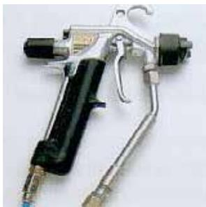
Nel caso di sistemi airmix, cioè airless più aria, la regolazione sulla pistola (foto a sinistra) risulta possibile. Essa agisce sia sulle dimensioni del ventaglio sia sulla polverizzazione (figura a destra) aprendo o chiudendo l'aria in arrivo all'ugello.
